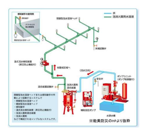
・火災発生箇所のみに泡水溶液を放射するので、シンプルで効果的 ※従来型は、区画内に一斉放射をするので、泡水溶液の容量が多い
