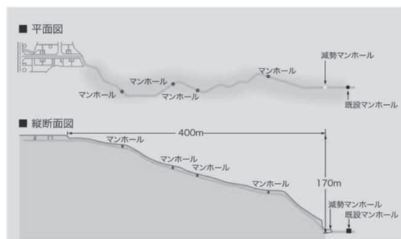
急傾斜排水方式による配管ルート
